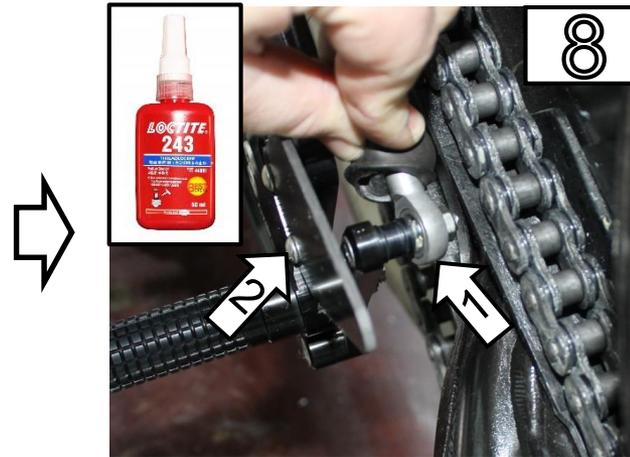
Montieren Sie die Schaltstange an Schalthebel(1). Anschließend kann der Fersenschutz montiert werden (2)
