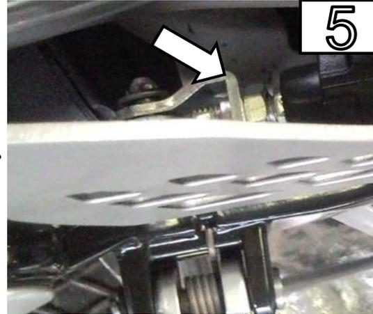
Entfernen Sie den Metallbügel vom Bremszylinder, dieser wird später durch ein Kugelgelenk ersetzt. /
